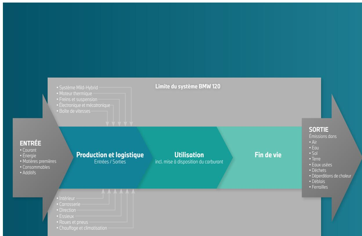
Fig. 1: Limite du système écobilan BMW 120
