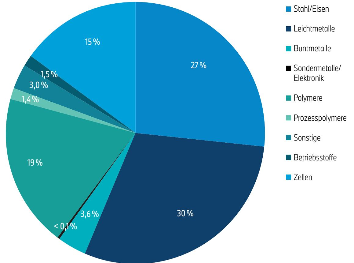
Abb. 2: Werkstoffzusammensetzung des BMW iX xDrive45 zum Produktionsstart.
