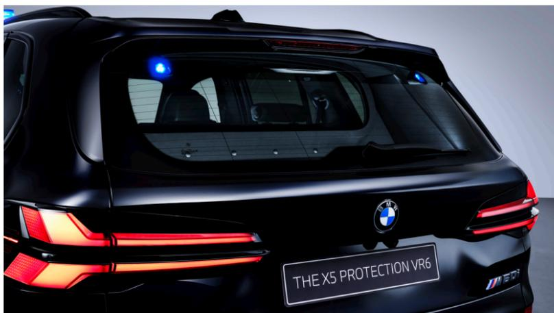
Zusätzliche **Blitzer**(1) an der Heckscheibe warnen den rückwärtigen Verkehr.
