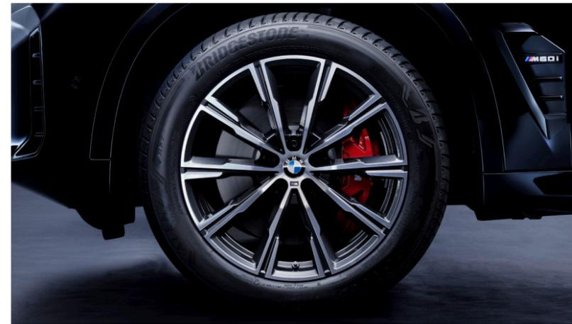
Die **M Sportbremse** mit Vierkolben-Festsattel vorn und Einkolben-Faustsattel hinten in Rot sowie mit M Schriftzug verfügt über größere Bremsscheiben und damit über eine besonders hohe Bremsleistung.
