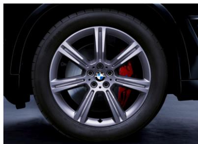
■ 20" Leichtmetallräder Sternspeiche 736 Ferricgrau mit Mischbereifung und Notlaufeigenschaften, Radgröße vorn 9J x 20, Bereifung 275/45 R20, Radgröße hinten 10,5J x 20, Bereifung 305/40 R20.
