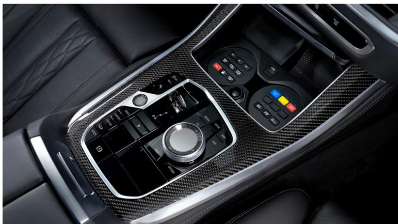
Die **Sondersignalanlage**(1) beinhaltet eine abnehmbare Rundumkennleuchte, Frontblitzer in der Niere sowie das Tonfolgesignal. Sämtliche Bedienelemente sind in einem Schaltzentrum vor dem Gangwahlhebel zusammengefasst. Im Falle eines Ausfalls der primären Energieversorgung ermöglicht der **Motor-Notstart**(1), per Tastendruck eine weitere Batterie zum Motorstart zuzuschalten.
